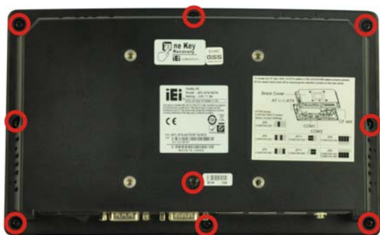
图表 5-1: 后盖螺丝钉
