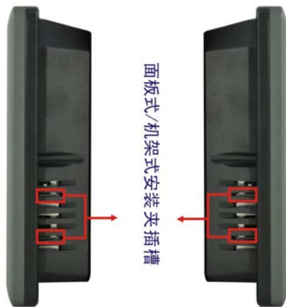
图表 1-6: AFL-10A-N270 侧面板
