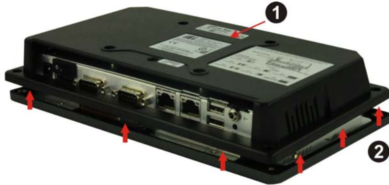
图表 4-2: 拆除塑料后盖
