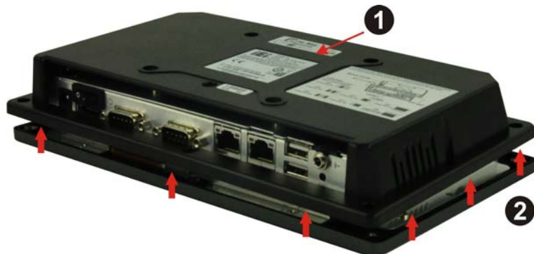
图表 5-2: 拆除 AFL-07A-N270 塑料后盖
