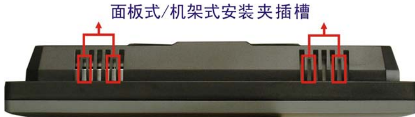
图表 1-5: AFL-07A-N270 顶部面板
