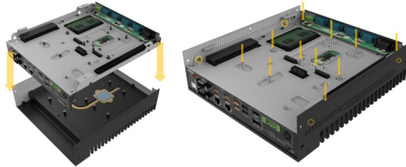
圖表 3-5: 安裝主板
