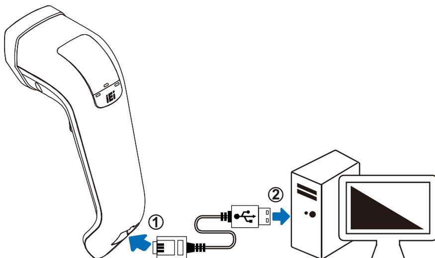
1. 將隨附的 RJ-45 轉 USB 連接線上的 RJ-45 接頭連接至讀碼器的 RJ-45 連接埠。接頭連接上時，請推至底部卡緊，需聽到喀一聲才算安裝成功。
