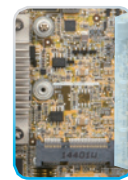
PCIe Mini slot PCIe Mini slot for full-size or half-size devices
